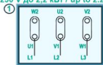
▲ Схеми / Scheme 230 V до 2,2 кВт / up to 2.2 kW
