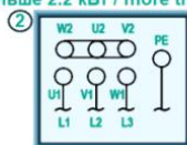
Υ Схеми / Scheme 400 V більше 2,2 кВт / more than 2.2 kW
